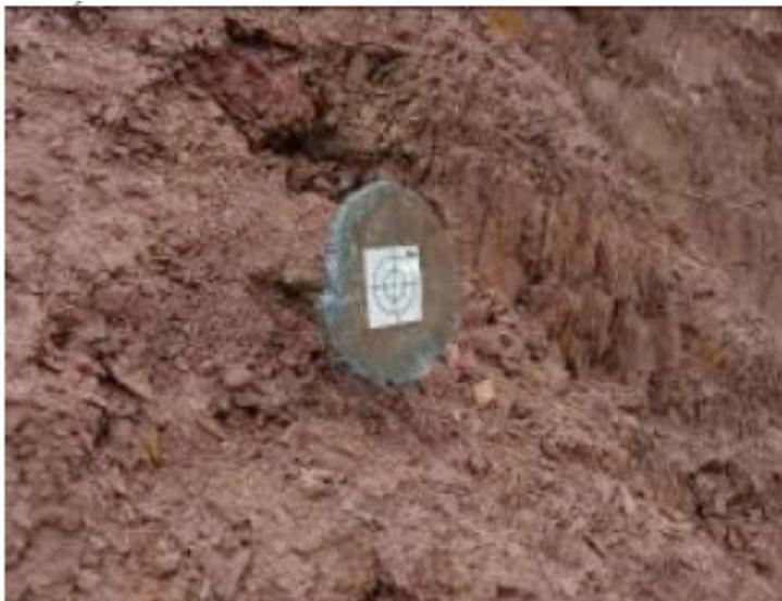
**Рисунок 4 - Репер с безотражательной пластиной, установленный в откосе**
