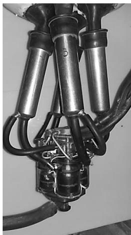
**Рис. 2. Экспериментальный образец доильного аппарата**
